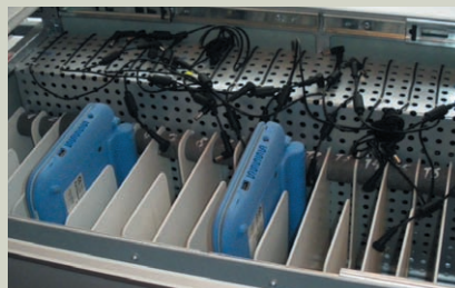
Так выглядит «начинка» учительского стола. Его верхняя крышка откидывается, и детские нетбуки закладываются внутрь для зарядки
